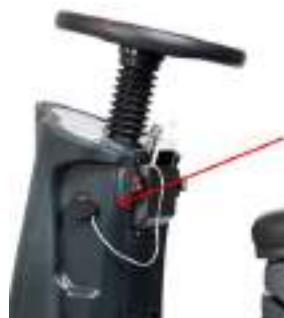
Встроенный USB разъем для зарядки мобильного телефона.
