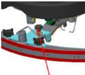
Для регулировки угла наклона всасывающего скребка используйте винт.
